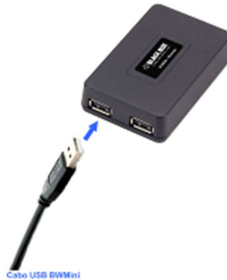
Conexión de BWMini al módulo remoto
